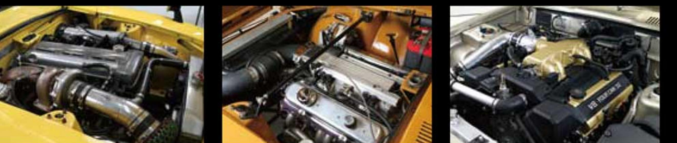
1974年製ニッサン・フェアレディZに搭載されている。トヨタ製の2Jエンジン、3.0リッター直列6気筒DOHC24に過給機を加え、バンチのあるパワーが魅力的だ。RBエンジンに比べると低速域のトルクが太いのが特長のひとつ。
